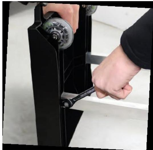
3. Conecta los 2 tubos cuadrados de aluminio en los orificios correspondientes de los dos módulos de soporte de plástico. Fija los tornillos autorroscantes (4,2 x 16 mm) con una llave combinada de 7 mm. Coloca la rueda encima del soporte.
