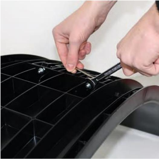
1. Encaja los 8 módulos de arco de plástico hasta que hagan clic. Fíjalos con los tornillos de conexión (M6 x 16 mm) y las tuercas correspondientes (M6). Para ello, necesitarás una llave Allen de 4 mm y una llave combinada de 10 mm.
